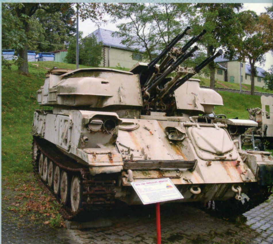
★ Модернизированный образец ЗСУ-23-4М4.
